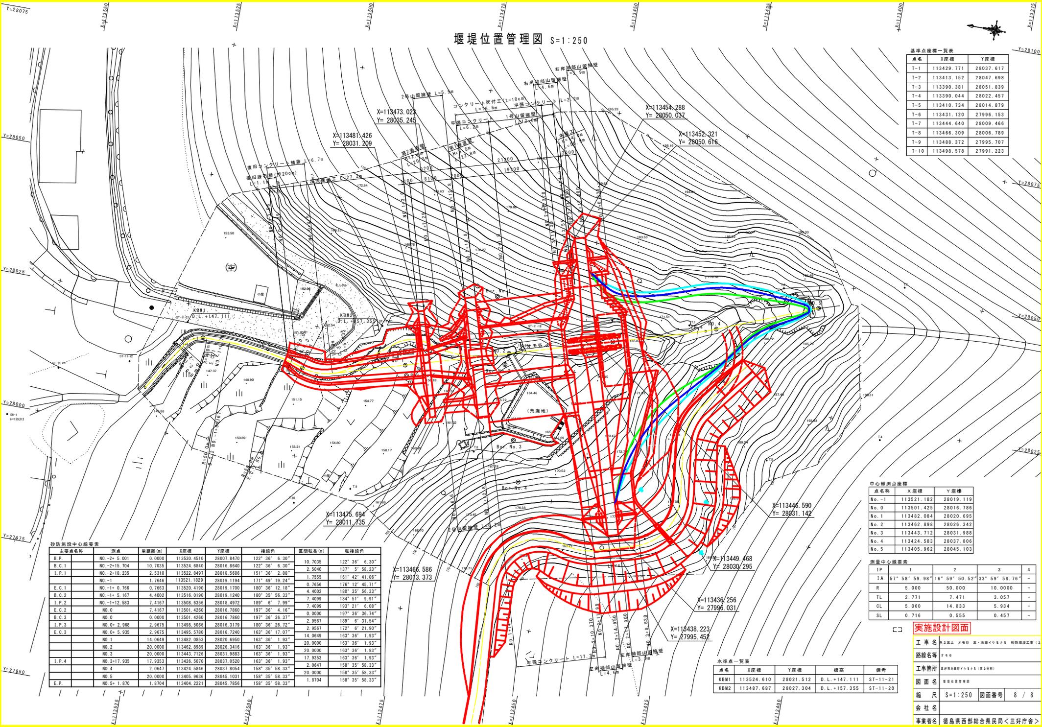
本図面の内は実測であり、外は砂防堰堤図による。
